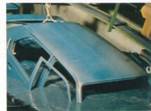
De hele carrosserie wordt ondergedompeld in een beschermend corrosiewerend elektroforesebad.
