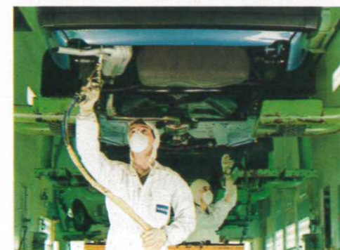
De anti-roestdokters van Volvo voorzien zelfs de kleinste hoeken en gaten van de juiste hoeveelheid roestwerend middel.
